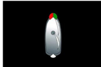
Oder: Zweifarbenlaterne und Hecklicht (kein Topplicht)
