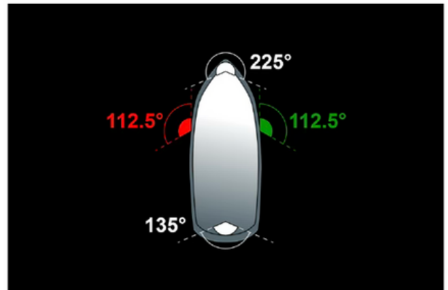
Sichtwinkel und Farben der Lichter eines Fahrzeugs unter Motor
