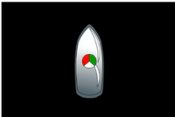
Entweder: Dreifarbenlaterne an der Mastspitze
