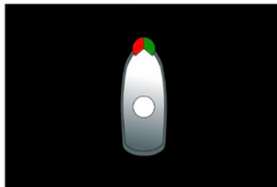
Oder: Seitenlichter als Zweifarbenlaterne und ein Rundumlicht im Top
